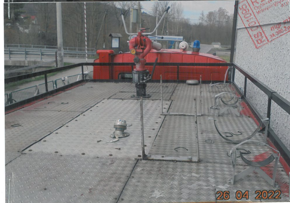
Ujęcie samochodu z góry. Zabudowa zbiornika na wodę , ujęcie armatki .
